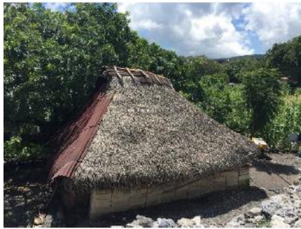
Vivienda híbrida, block y bajareque, lámina y palma Barrio de Santiago
