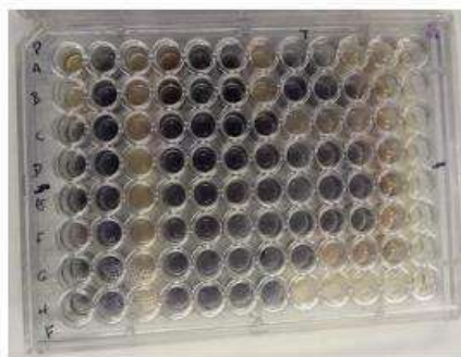
Figura 2. Repetición del MIC se observan los cambios de coloración en las diluciones seriadas, la concentración mínima inhibitoria fue de 25 µl. Señala a que fila corresponde cada compuesto
