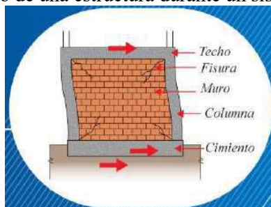
Figura 3. Comportamiento de una estructura de mampostería durante un sismo. Fuente: Aceros Equipa.
