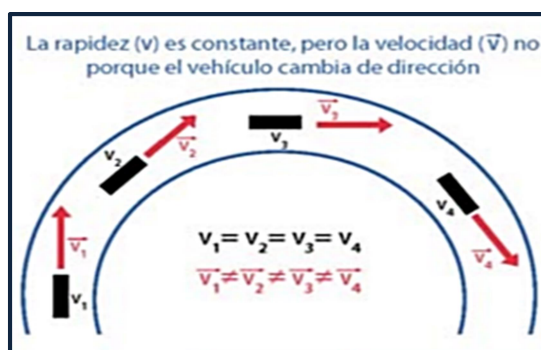
Figura 3. En la figura el símbolo \vec{v} se refiere a la velocidad y se representa con un vector, y el símbolo v se refiere a la rapidez y se representa con un segmento de recta. En Ciencias 2 Física (p. 21), por J.A. Chamizo, 2014, México: Editorial Esfinge. Derechos reservados por Chamizo, José Antonio (2014) y Editorial Esfinge S. de R.I. de C.V. (2014).
