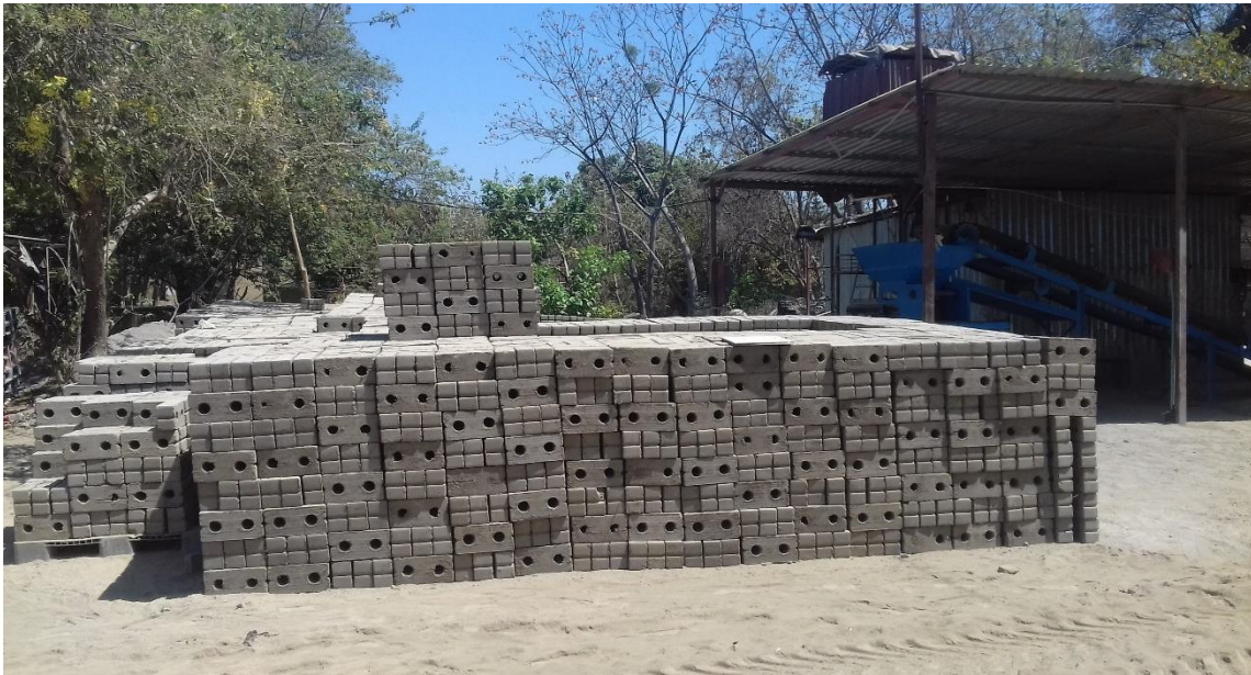
Foto 15: Producto final obtenido de la fabricación del block de adobe
