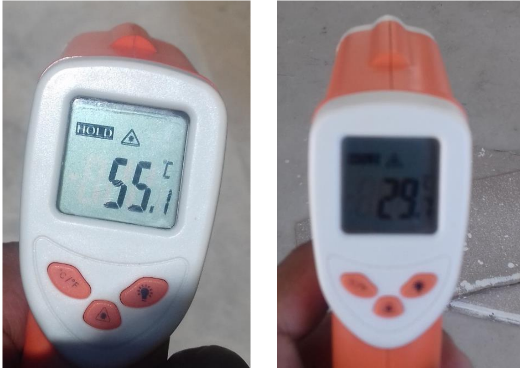
Foto 21: Comprobación de temperatura al interior y exterior de las viviendas
