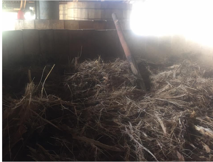
Figura 12. Fermentado de agave en tinas de madera, este proceso dura de 5 a 11 días aproximadamente.
