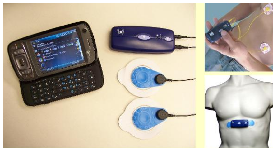
Fig. 2.7. HeartToGo sistema para medir ECG por la Universidad de Pittsburg (Jin et al., 2009).
