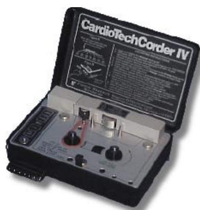
Fig. 2.2. Holter portátil capaz de grabar en cinta magnética (Holter, 1957).
