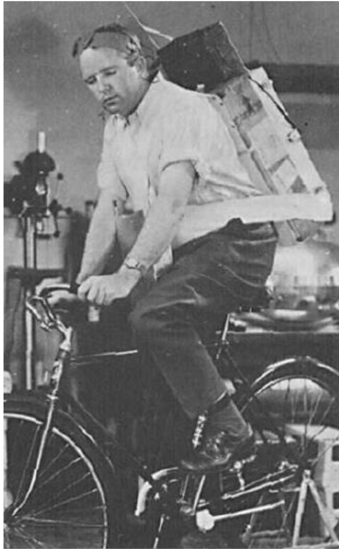
Fig. 2.1. Holter original de 38 kg (Holter, 1957).
