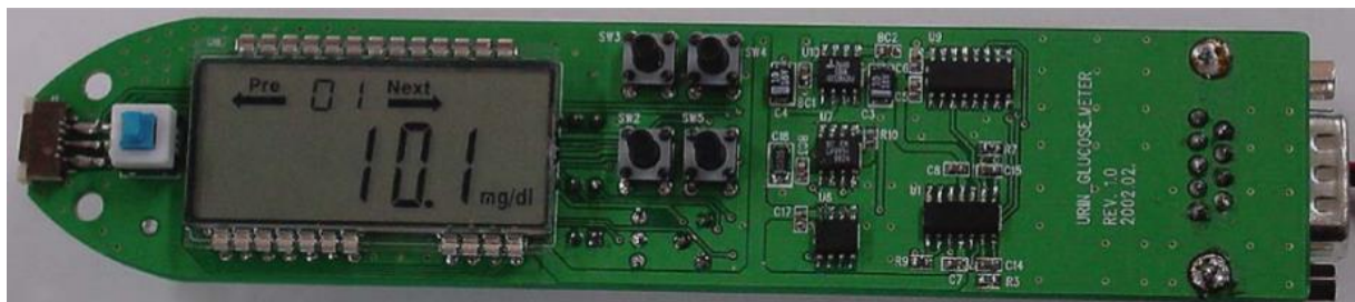
Fig. 2.5. Sistema para medir niveles de glucosa a través de la orina (Park et al., 2005).
