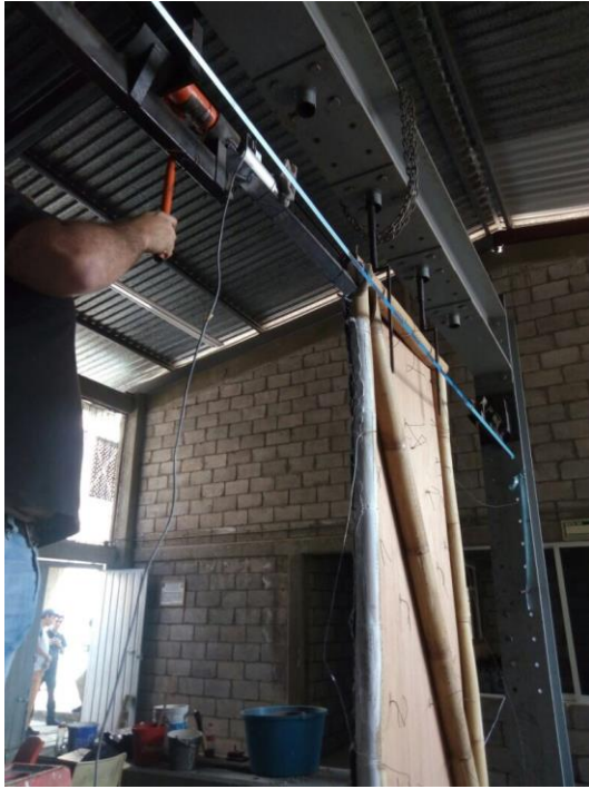
Figura 3.2.15. Aplicación de carga al módulo de bambú.
