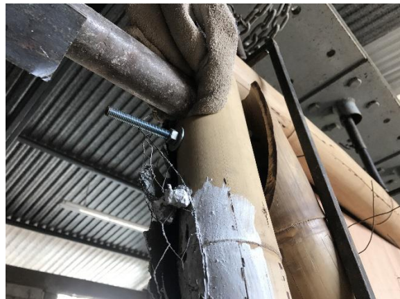
Figura 3.2.16 Lugar de contacto del gato y la extensión, y las grietas existentes marcadas previamente a la prueba.
