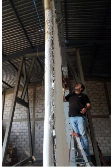
Figura 3.2.15. Aplicación de carga al módulo de bambú.
