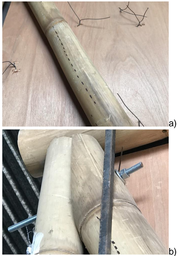
Figura 3.2.17 fallas después de la prueba en el módulo de bambú.
