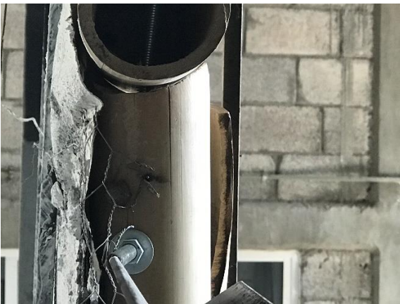
Figura 3.2.16 Lugar de contacto del gato y la extensión, y las grietas existentes marcadas previamente a la prueba.
