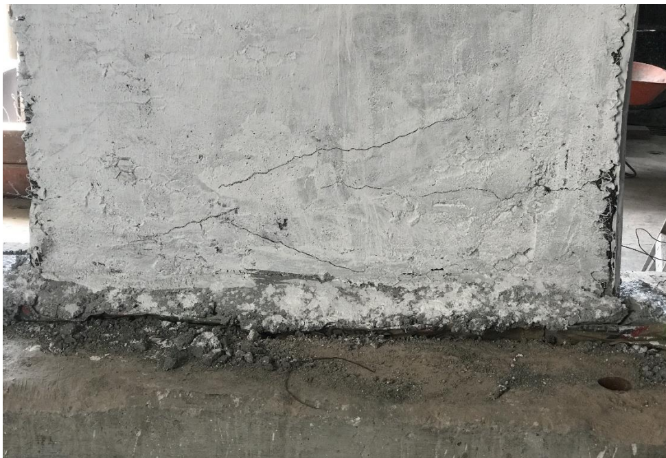
Figura 3.2.19 Patrón de agrietamiento producido por el esfuerzo aplicado.
