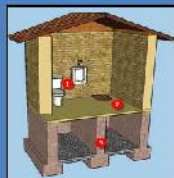
Figura 3. Vista interior del baño seco
