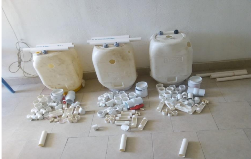
11. Construcción en serie de los biodigestores rígidos DM1® modelo de laboratorio
