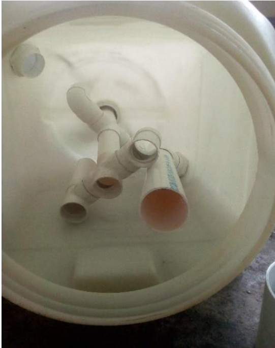
9. Parte interna de los Biodigestores rígidos DM1® modelo de laboratorio
