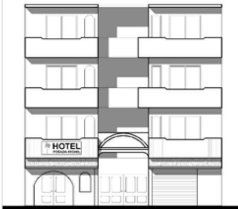
Figura 5.88 Uso de vanos redondeados y rectos en hotel Posada Michel . Fuente: Elaboración propia.
