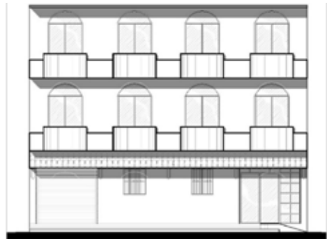
Figura 5.91 Uso de vanos redondeados y rectos en hotel Lumon . Fuente: Elaboración propia.
