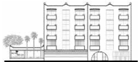
Figura 5.87 Uso de vanos redondeados y rectos en hotel Imelda . Fuente: D. G. Adame, D. Leonardo y B. Rivera.
