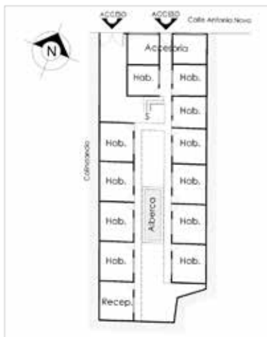
Planta baja del hotel Casa Miriam. Fuente: D. G. Adame, D. Leonardo y B. Rivera.
