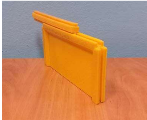
Fig. 2.30 Impresión 3D del modelo geométrico de las piezas A y B.
