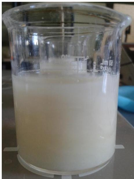
**Figura 2.** Suspensión de recubrimiento a base de almidón de maíz gelatinizado conteniendo las ZnO NPs.
